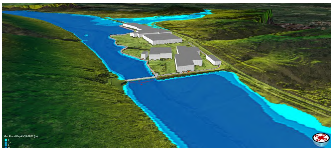
Slika 7: Prikaz rezultatov hidravličnega modela za novo stanje pri pojavu stoletnih voda
